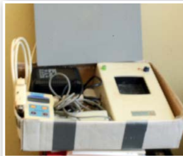
Belgický nasazovací systém na přesný elektronický záznam doletu poštovních holubů „Bricon“ - nasazovací jednotka (matka), hodiny Bricon - Spedy, anténa (pocha) pod přistávací desku na vletu, atomový čas, transformátor a propojovací kabel.
