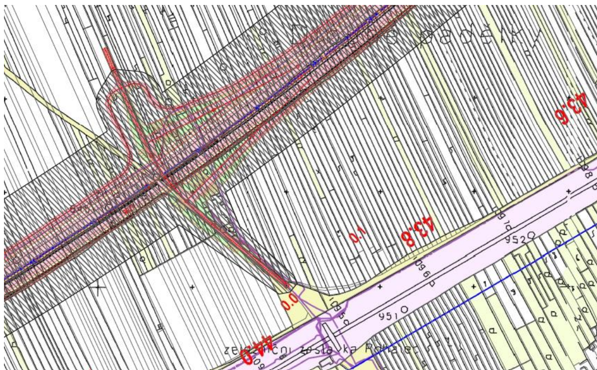
Navržená úprava koridoru pro dálnici D55 v místě jeho křížení s místní komunikací v ul. Za Tratí
